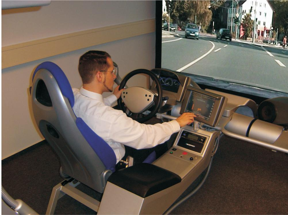
Abbildung 6.2: *VideoSim* im Fahrsimulator zur HMI-Forschung
