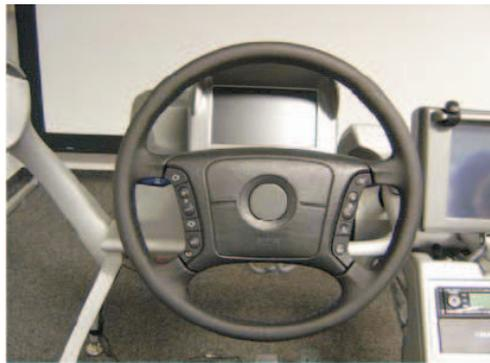
Abbildung C.3: BMW-Multifunktionslenkrad der Baureihe E38
